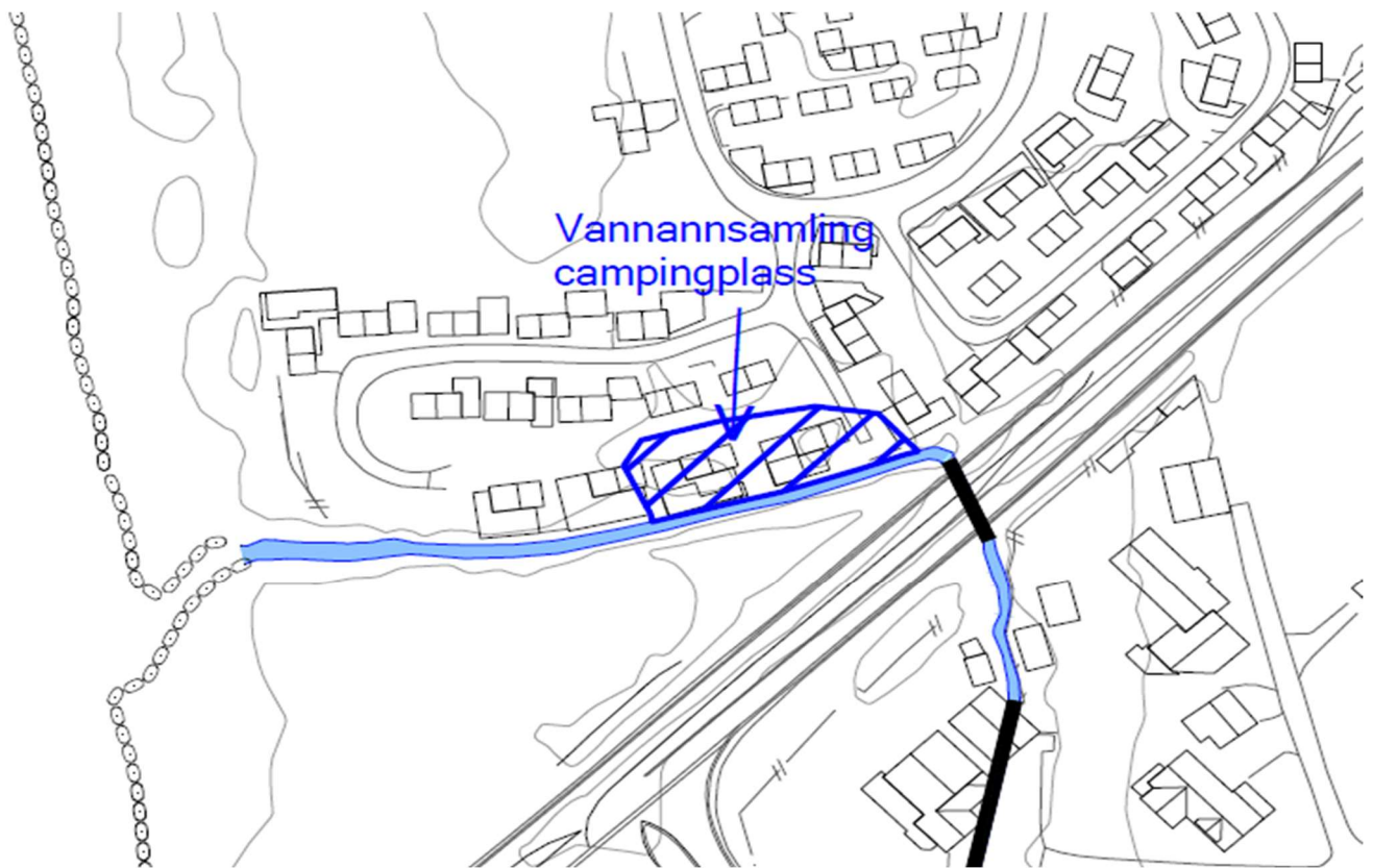
Figur 12. Område av campingplassen hvor det blir stående vann.
